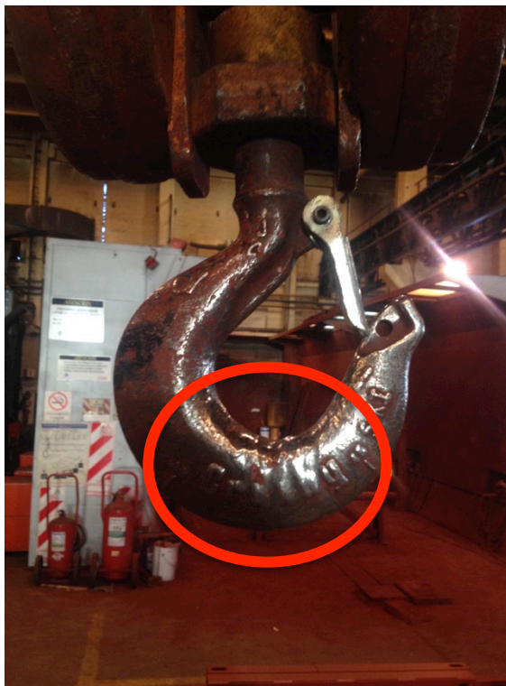
Figura 16 – Gancho com sinais de desgaste pela abrasão das correntes
