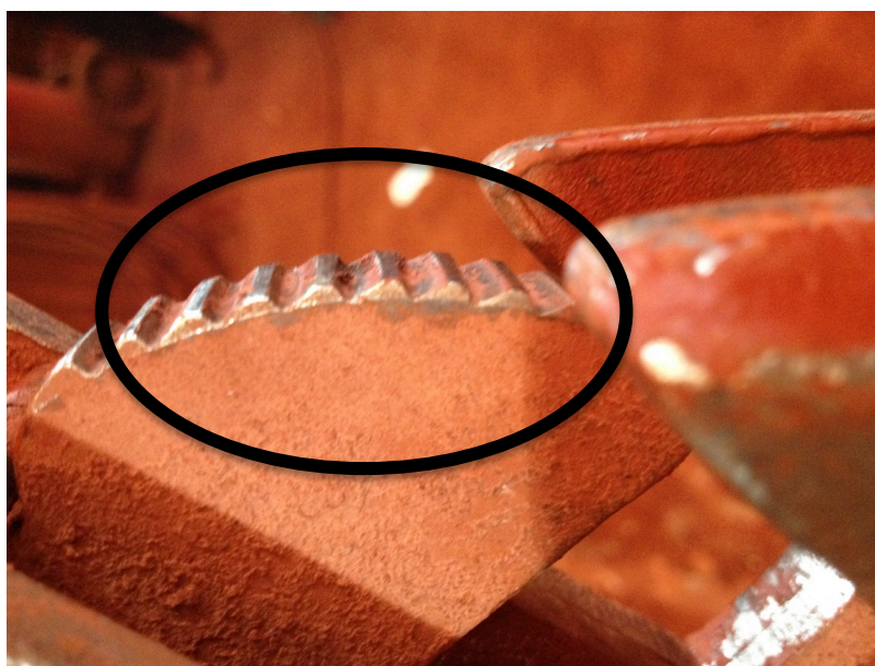
Figura 29 – Grampo com os dentes de fixação gastos
