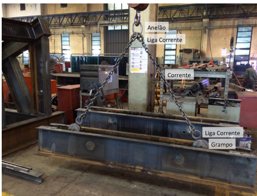
Figura 9 – Eslinga montada no formato adequado
