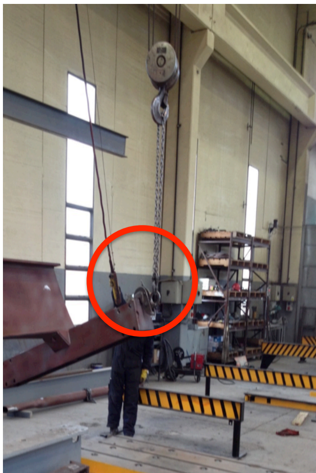
Figura 27 – Uso de grampo horizontal em elevação para grampo vertical
