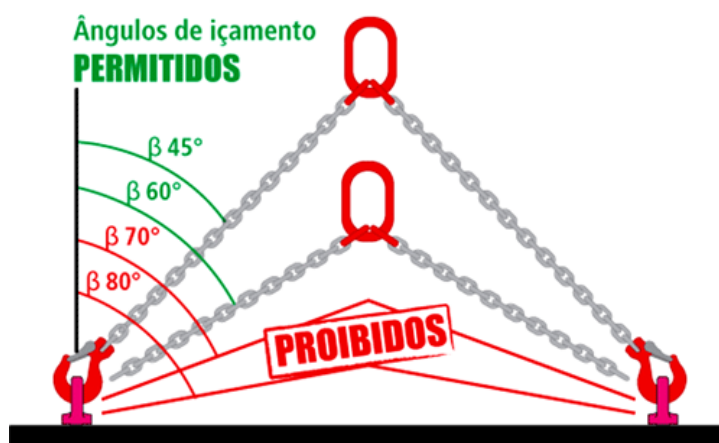
Figura 15 – Ângulos permitidos para elevação de carga
